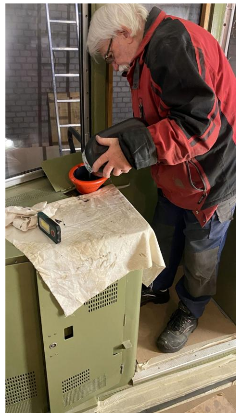
Bild 8 Röbi Ziegler befüllt den Behälter für die Spurkranzschmierung
