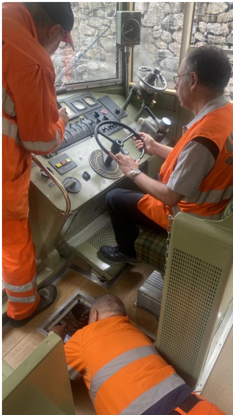
Bild 16 Sepp fährt · Peter liest den Fahrstrom an den Instrumenten ab · Felix am Fahrmotor
