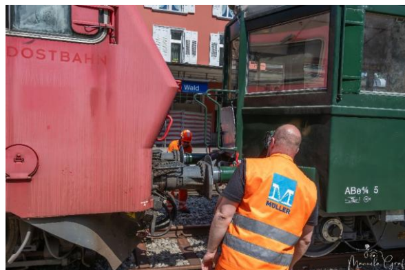
Bild 10 Felix kuppelt den Triebwagen mit der Lok (Bild Manuela Graf)
