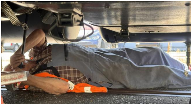
Bild 19 Bei schwierigen Verhältnissen arbeitet Willi am Ausbau des Kompressors
